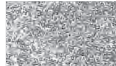
Feinstkorn-Hartmetall-Kornstruktur Ultra-Micro-Grain, Korngrößen 0–0,5 µm. Finegrain-hardmetal structure Ultra-micro-grain, grain size 0–0.5 micron. Struttura dei granuli di metallo duro Ultra Micro Grana (max 0,5 micron).
